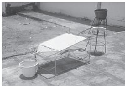
Figura 2. Reator fotocatalítico de placa plana
