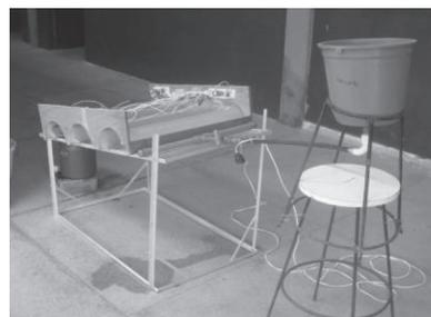
Figura 4. Refletores semi-circulares montados acima do fotorreator
