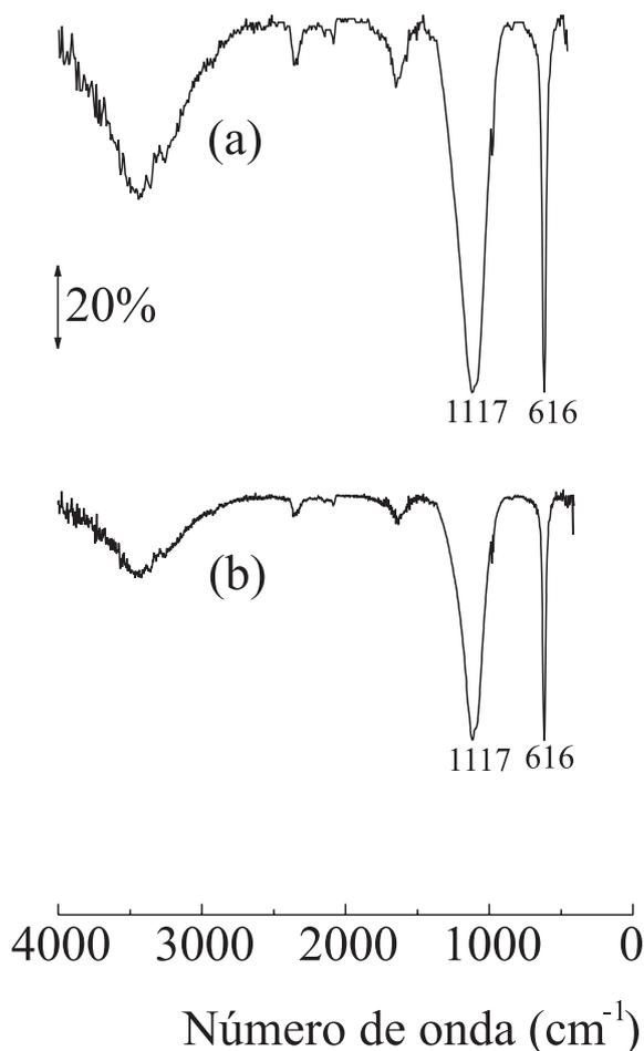
Figura 1S. Espectros na região do infravermelho (a) do padrão de tiosulfato de potássio e (b) do resíduo de decomposição do K<sub>2</sub>Pyr coletado a 300 °C
