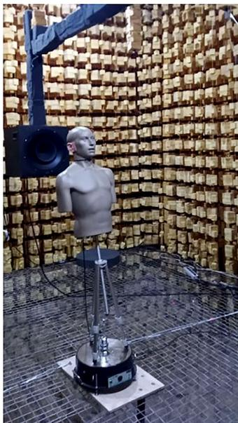
**Figura 4:** Câmara anecoica do INMETRO.
