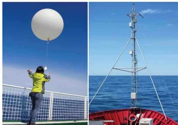
**Figura 7** - (esq.) Lançamento de radiossondas realizado a partir de um navio oceanográfico. (dir.) Torre micrometeorológica com diversos sensores instalada na proa do NPo. Almirante Maximiano durante a Operação Antártica 33 (OPERANTAR XXXIII) em novembro de 2014.
